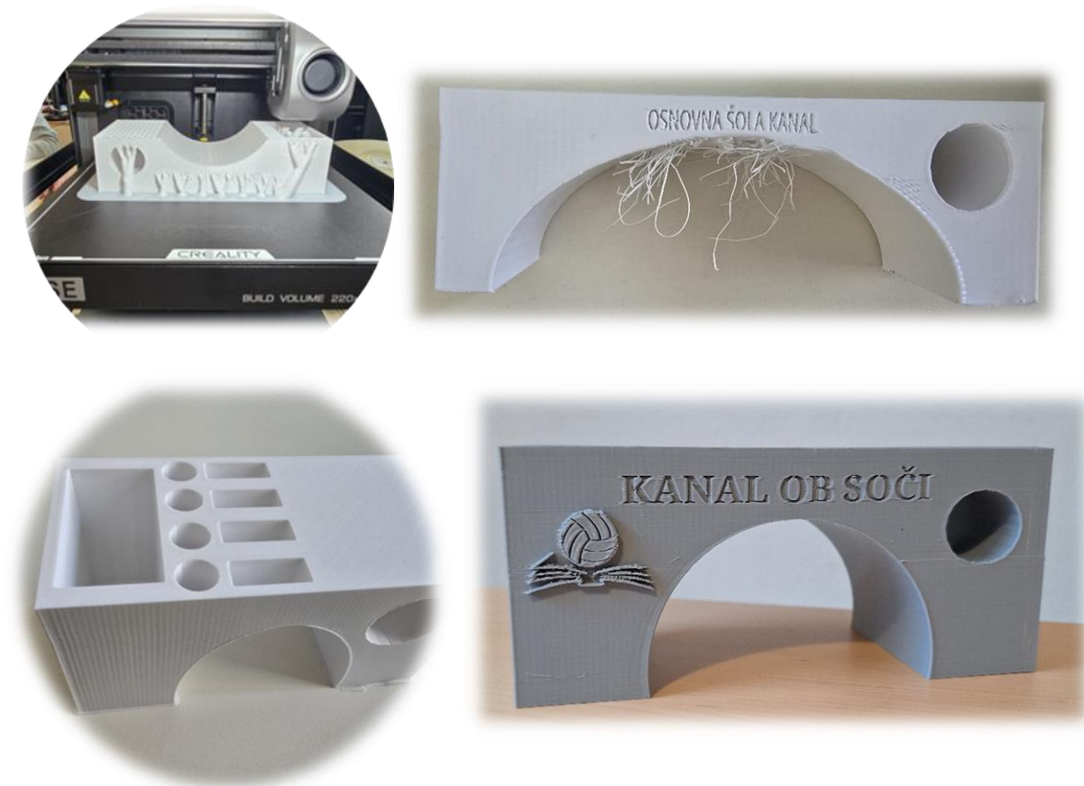
Slika 8: Postopek izdelave Namiznega mostu, vmesni in končni izdelek (Vir: Nace Strnad, 2025).
